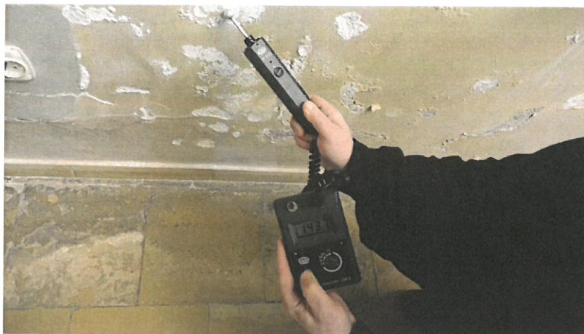
Zdj. 13. Pomiar zawilgocenia lica muru – ściana wschodnia (fot. C Magott)
