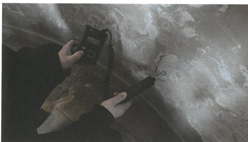
Zdj. 14. Poziom zawilgocenia – ściana zachodnia. Pomiary zawilgocenia ścian nawy przeprowadzono miernikiem Gann Hydromette Uni 2 (fot. C Magott)
